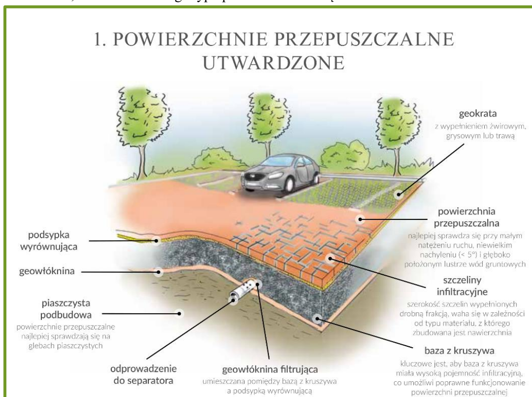
Zdjęcie 18. Schemat działania utwardzonych powierzchni przepuszczalnych
