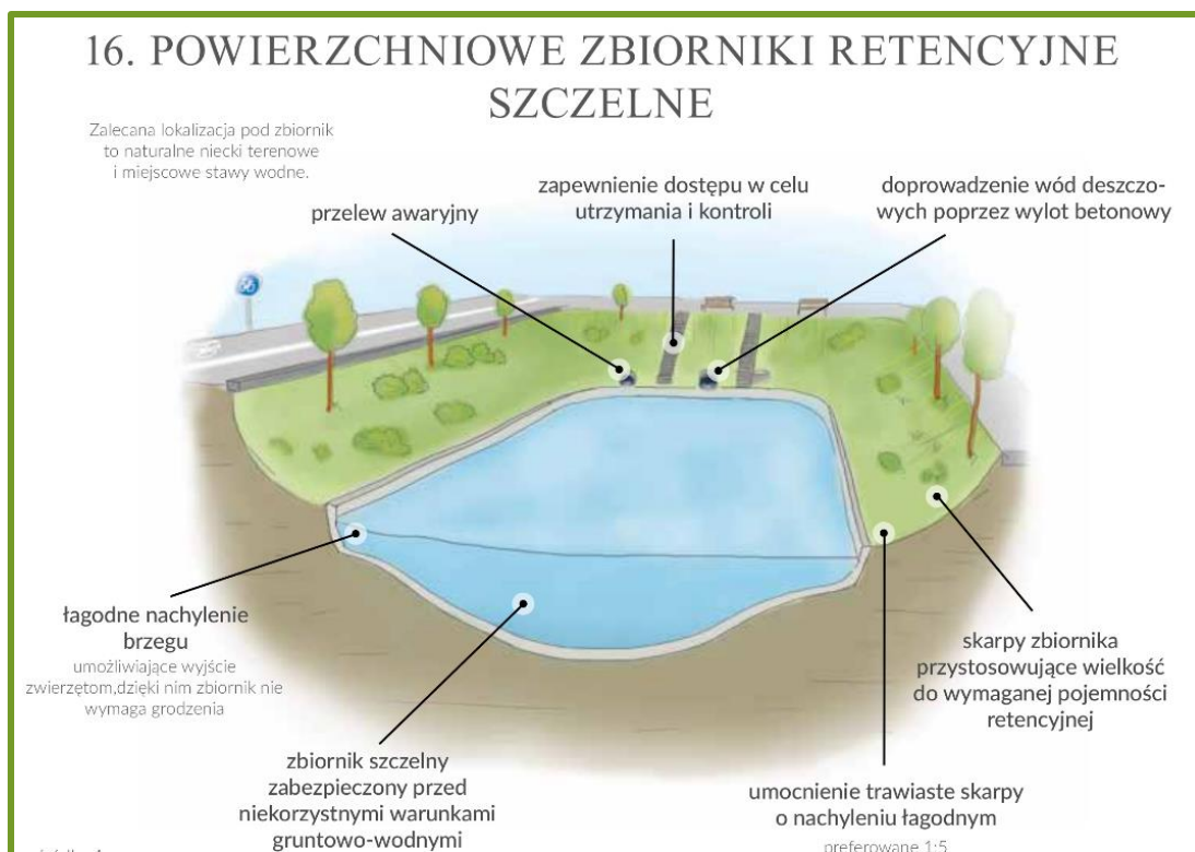
Zdjęcie 33. Schemat działania powierzchniowego zbiornika retencyjnego szczelnego
