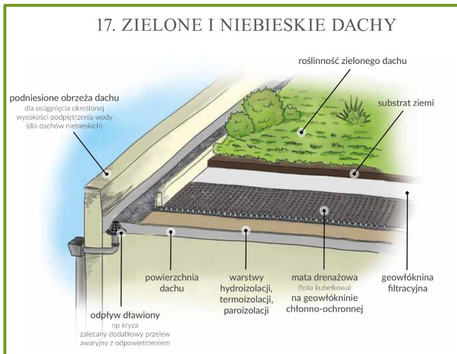
Zdjęcie 34. Schemat działania zielonych dachów
