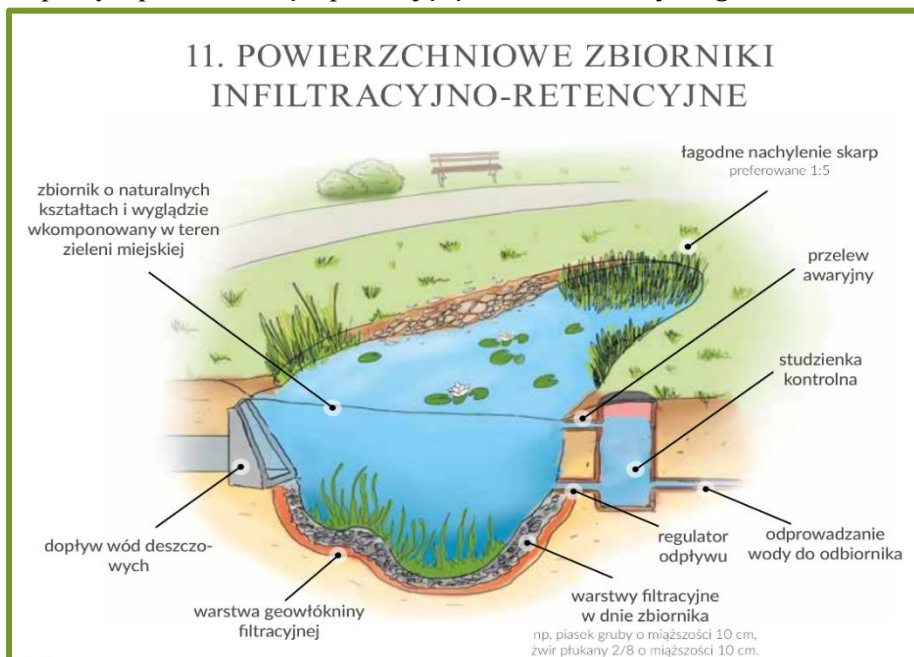
Zdjęcie 28. Schemat działania powierzchniowego zbiornika infiltracyjno-retencyjnego
