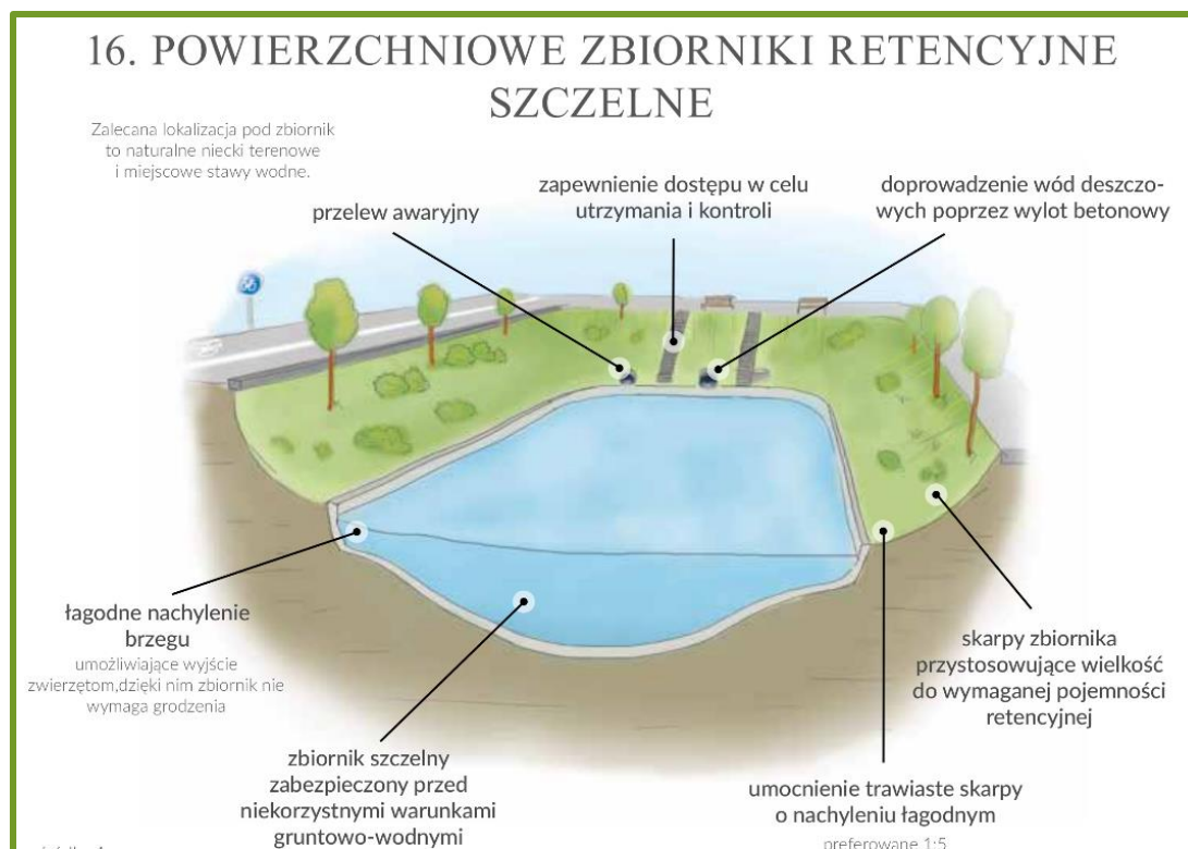
Zdjęcie 33. Schemat działania powierzchniowego zbiornika retencyjnego szczelnego
