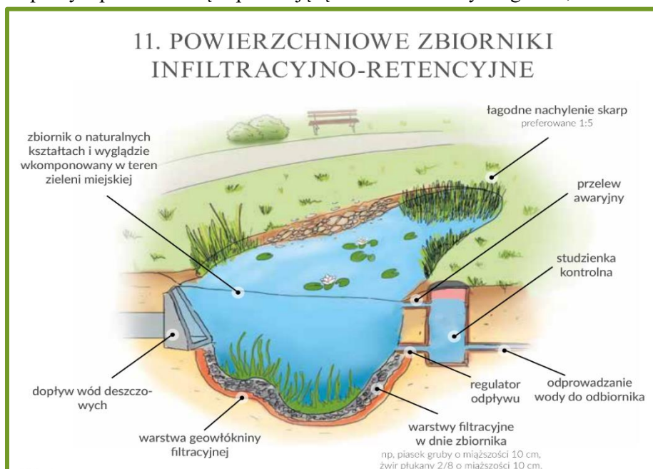
Zdjęcie 28. Schemat działania powierzchniowego zbiornika infiltracyjno-retencyjnego
