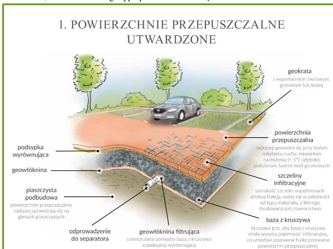
Zdjęcie 18. Schemat działania utwardzonych powierzchni przepuszczalnych
